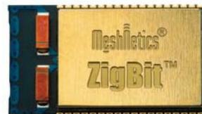
Módulo IEEE802.15.4/ZigBee con chip antena
